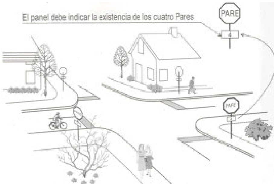
Figura 4.20 Cruce con cuatro brazos y cuatro pares.
