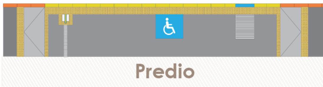
Imagen 22. Zona paradero en franja de circulación peatonal (FCP)
