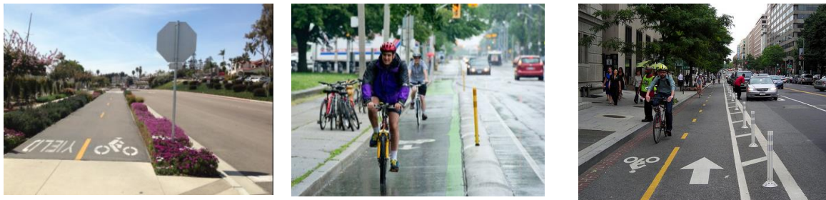
Ilustración 12. Ejemplos de segregación física para ciclorruta en calzada
