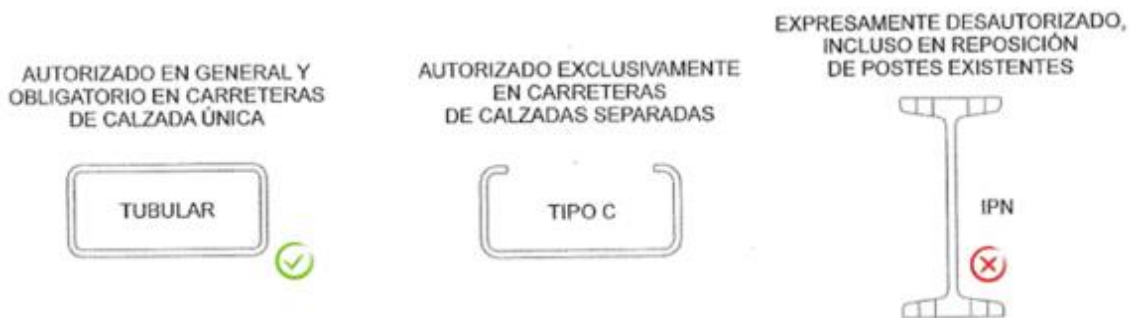
Figura 17. Tipos de postes para barreras metálicas.
