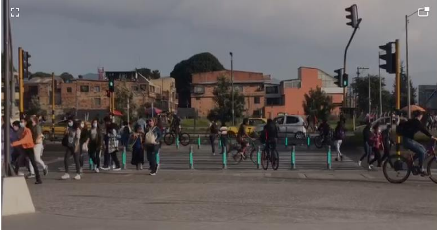
Bolardos luminosos (BOSEP) , repetidores de la señalización semafórica peatonal Piloto Centro Comercial Nuestro Bogotá - SDM
