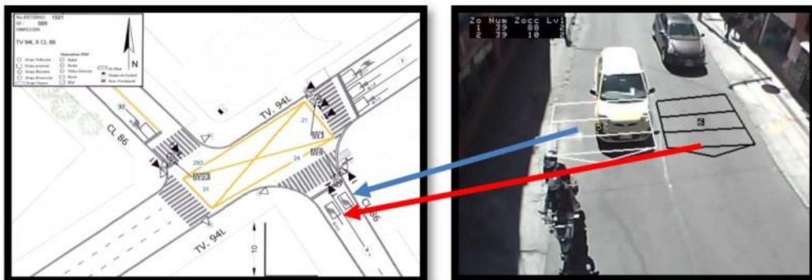
Imagen 3: Ubicación de Zona de Video Detección. Zona 5 Activada por ocupación (Flecha Azul) – Zona 6 NO activada (vehículo detenido fuera de la zona de detección – Flecha Roja)
