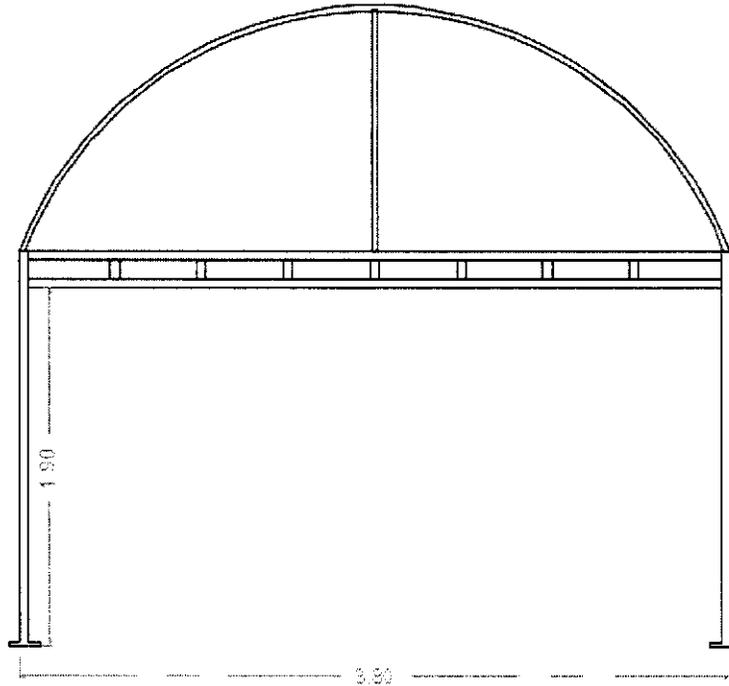
**Figura 1. Vista frontal estructura metálica de la carpa**
